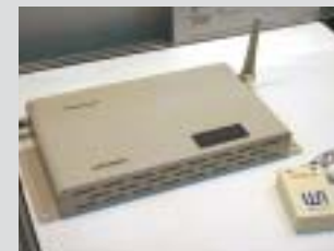
日立電線が出品した無線LAN位置情報システム「日立AirLocation」。工場や自動車展示場などでの利用を想定しているという。出荷は今年秋になる予定
