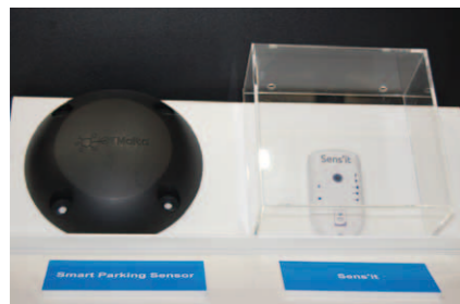
センサーデバイス「Sens'it」は6種類のデータをSIGFOXでクラウドに送信する
