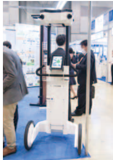
NavVis の「M3 Trolley」は、押して動かしながら屋内を測定する
