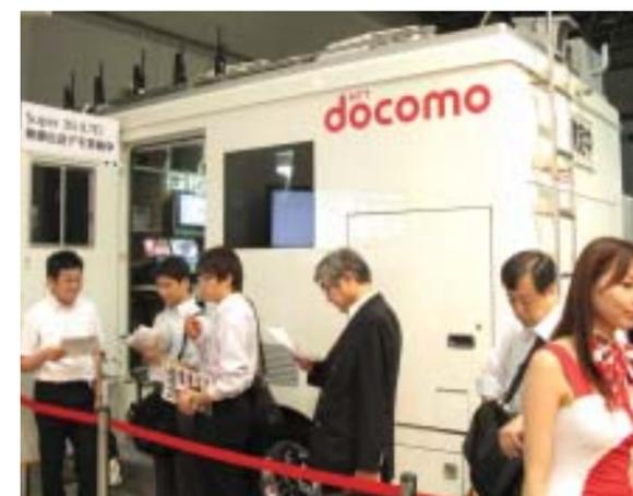
ドコモのLTEデモで用いられた端末局車両。MIMOに対応するために複数のアンテナが装備されている
